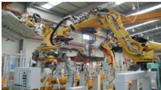
Промышленные роботы могут выполнять основные технологические операции (сварка, окраска, сборка и др.) и вспомогательные технологические операции (загрузка-выгрузка технологического оборудования, транспортные и др.). При использовании сменной технологической оснастки выполняемые операции могут совмещаться одним роботом.
