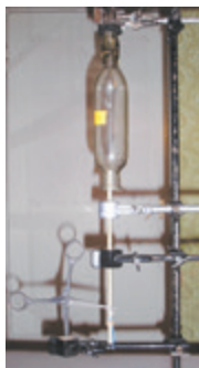
Рис.2. Одноголосый огненный орган на основе делительной воронки
