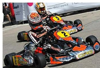
Класс «**Superkart**» (двигатель Honda), 2 цилиндра, воздушное или водяное охлаждение, с КПП, объем цилиндров 250сс.
