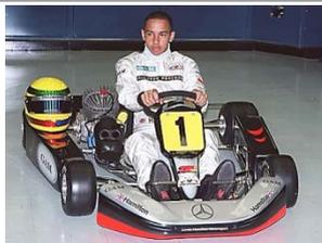
Класс «**KF1**» (двигатель Vortex, IAME), 1 цилиндр, водяное охлаждение, без КПП, объем цилиндра 125сс
