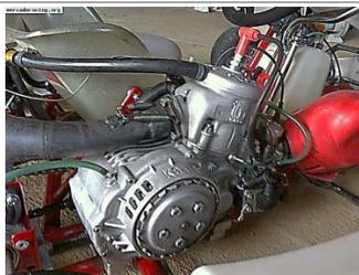
Класс «**KZ1 u KZ2**» (двигатель TM10b, Vortex, Maxter, Iame, Debei), 1 цилиндр, водяное охлаждение, с КПП, объем цилиндра 125сс.
